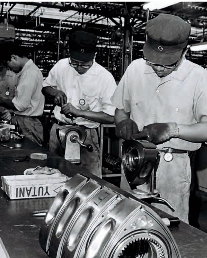
Die Herstellung eines Kreiskolbenmotors erfordert enorme Präzision.
